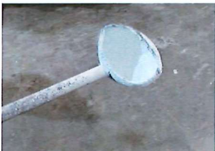
กระบวยที่ใช้งานในขณะนั้น ผู้ปฏิบัติงานได้ปรับเปลี่ยนรูปทรง เพื่อให้ง่ายต่อการเทลงแบบหล่อ
